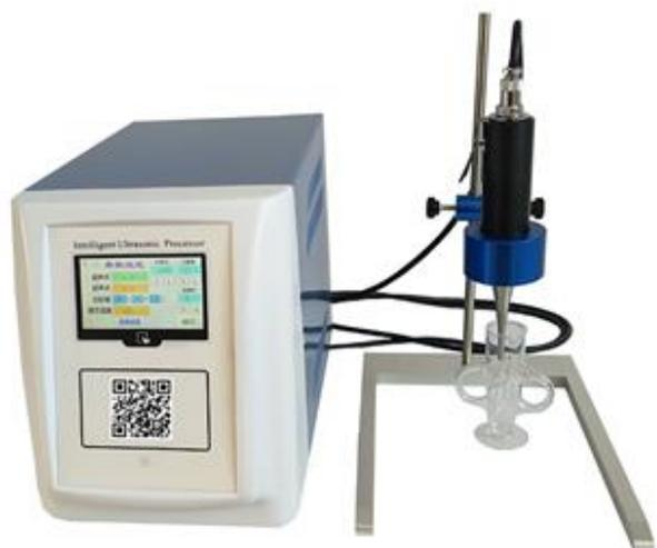
手持式超声波破碎仪外观美，性能可靠。仪器采用大屏幕显示，中央微机集中控制，超声时间，功率任意设定，样品温度检测显示、频率微机跟踪、故障自动报警。所有功能都显示在液晶大屏幕中。
